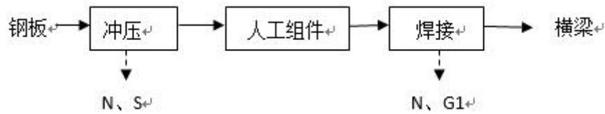
图 3.5 横梁焊接工艺流程及产污节点图
